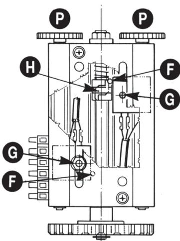
Чтобы открыть ворота вручную, необходимо открыть картер с помощью специального ключа, установить фигурный ключ R1B в разблокирующий болт и повернуть три раза против часовой стрелки.
